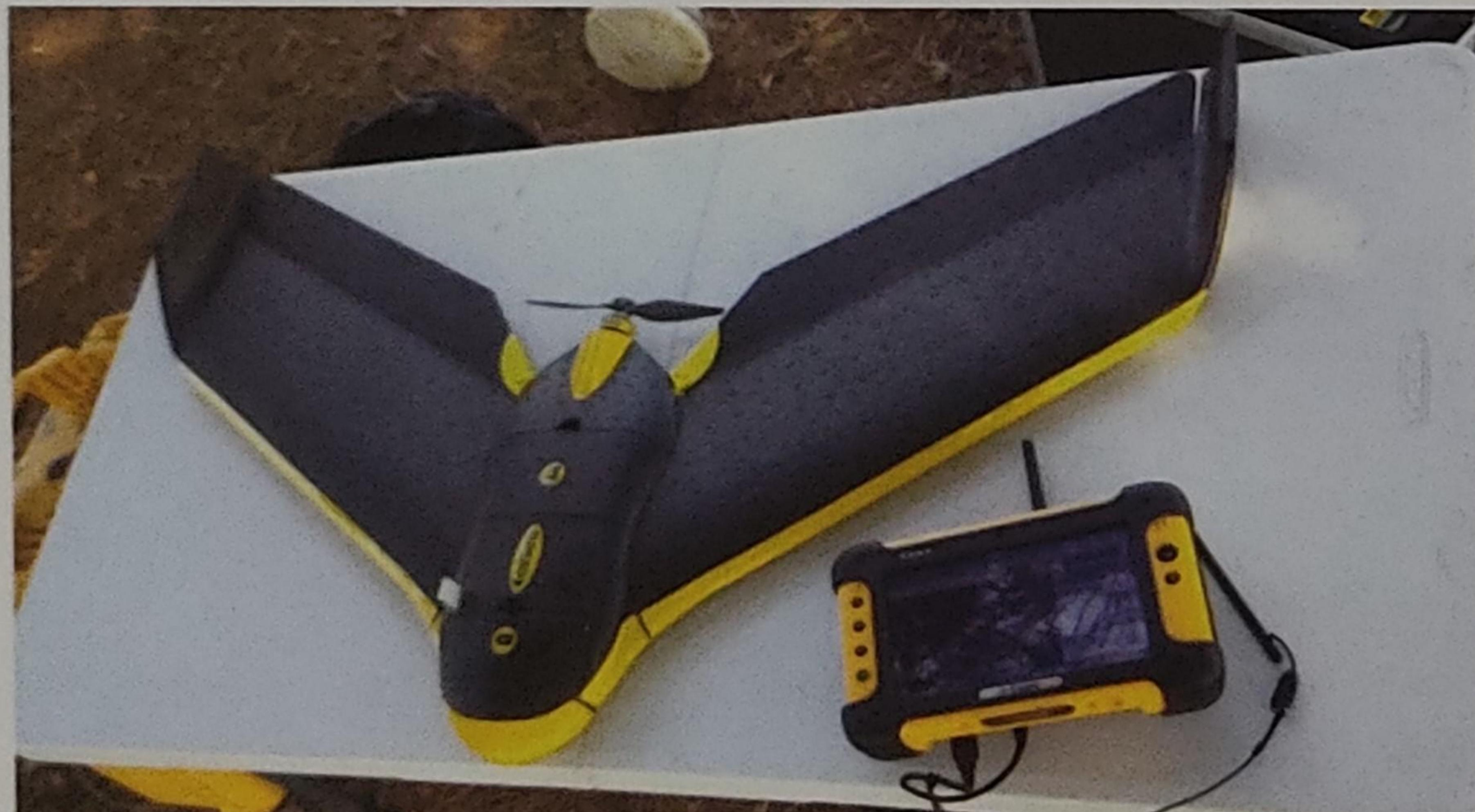
شکل ۱- نمونه‌ای از پهپاد بال ثابت senseFly eBee
